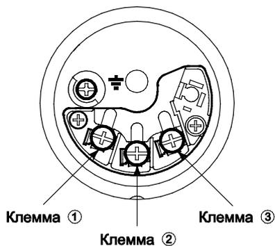
● Расключение клемм для выхода 4...20 мА для связи по протоколам FOUNDATION Fieldbus и PROFIBUS PA
