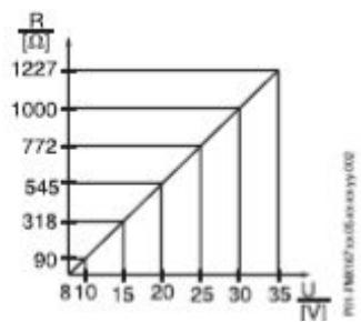
Диаграмма нагрузки датчика температуры для оценки сопротивления нагрузки.
