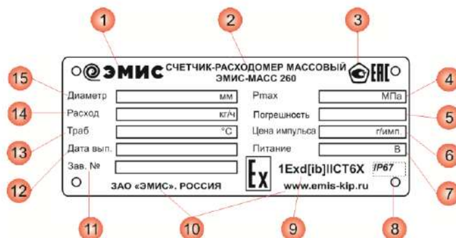
Рисунок 1.5 - Основная табличка расходомера
