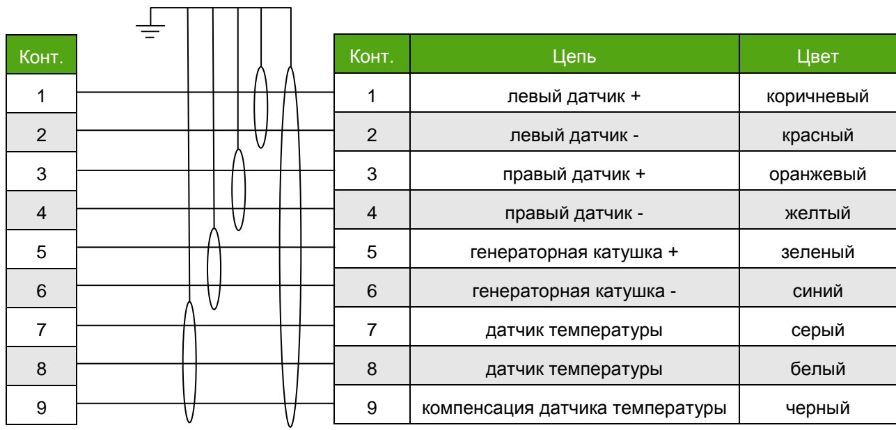
Рисунок Б.12 – Схема подключения электронного преобразователя при дистанционном монтаже
