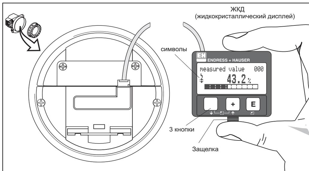
Дисплей VU331 может быть легко снят простым нажатием на защелку (см. рисунок выше). Он подключен к прибору кабелем длиной 500 мм.
