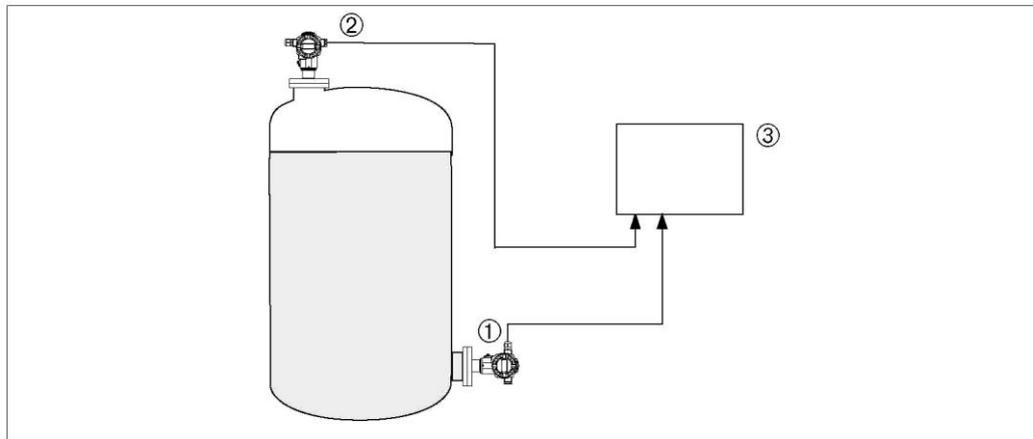
*Измерение плотности в закрытом резервуаре с наложением давления*
