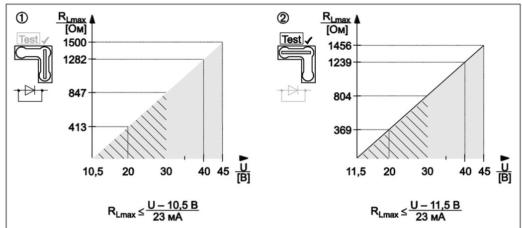
Диаграмма нагрузок, содержащая информацию о положении переключки и требованиях взрывозащиты (см. → 16, "Измерение тестового сигнала 4...20 мА").
