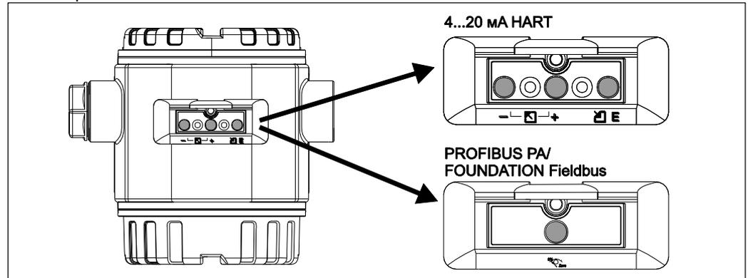
Функциональные кнопки, размещенные снаружи на корпусе прибора работают по принципу датчика Холла. Таким образом, потребность в дополнительных отверстиях отсутствует. Это обеспечивает:
