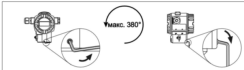
Ориентирование корпуса отвинчиванием установочного ключа
