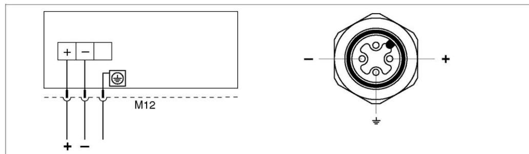
Слева: электрическое подключение устройств с разъемом M12
