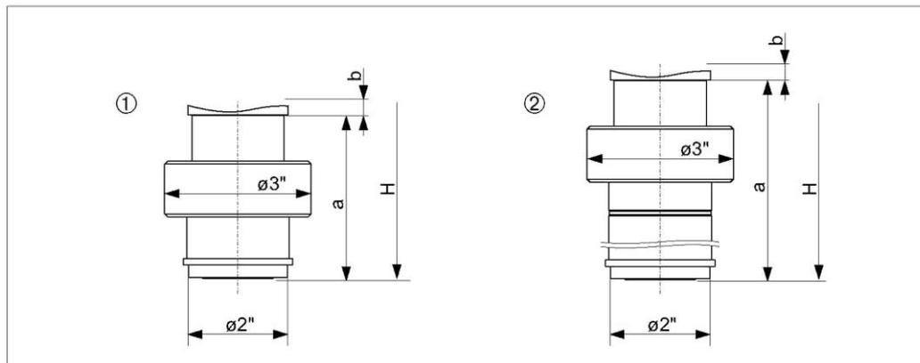
Присоединение к процессу FMB70, материал: *b* = верхняя секция AISI 316L (1.4404), *a* = нижняя секция AISI 316L (1.4435), корончатая гайка AISI316L (1.4404); Шероховатость поверхности, контактирующей с продуктом, стандартно:  $Ra \leq 0,76$  мкм (30 мкдм). Меньшая шероховатость – по запросу.
