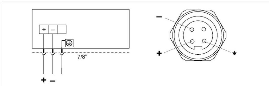
Слева: электрическое подключение приборов с разъемом 7/8"
