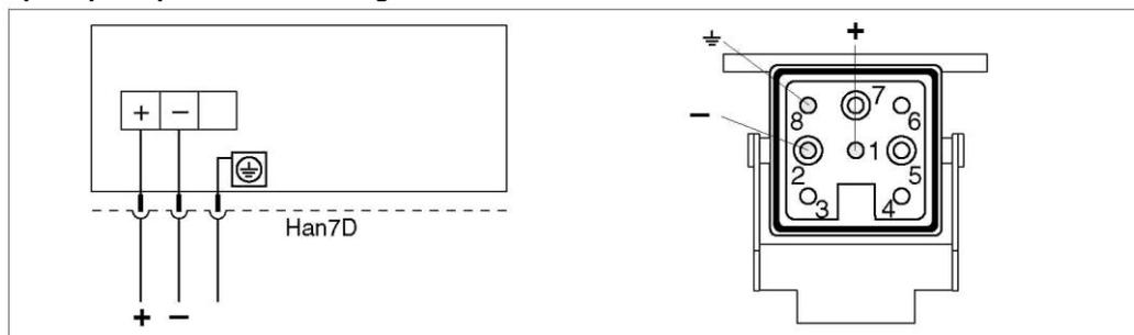
Слева: электрическое подключение устройстве с разъемом Harting Han7D
