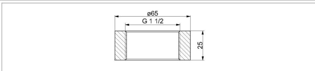
Приварная бобышка для установки Deltapilot S с резьбой ISO 228 G 1 1/2 A, AISI 316L (1.4435) заподлицо. Номер заказа: 52024469, номер заказа с сертификатом проверки 3.1: 52024470
