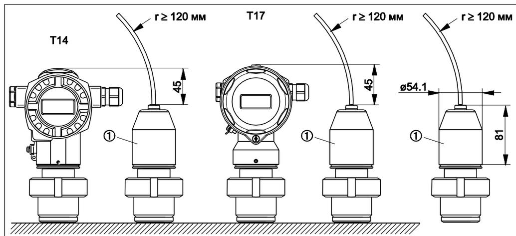
Сокращение монтажной высоты подключения к процессу при использовании раздельного исполнения
