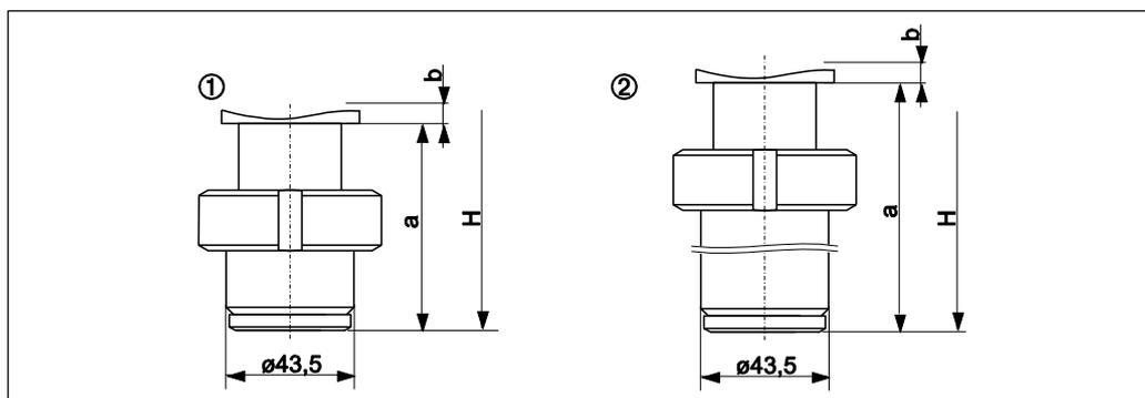
Присоединение к процессу FMB70, материал:  $b$  = верхняя секция AISI 316L (1.4404),  $a$  = нижняя секция AISI 316L (1.4435); Шероховатость поверхности, контактирующей с продуктом, стандартно:  $R_a \leq 0,76$  мкм (30 мкдм). Меньшая шероховатость – по запросу.
