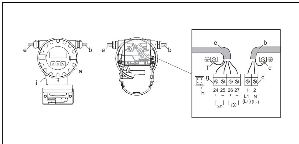
Подключение трансмиттера (алюминиевый корпус), макс. поперечное сечение кабеля 2,5 мм<sup>2</sup>
