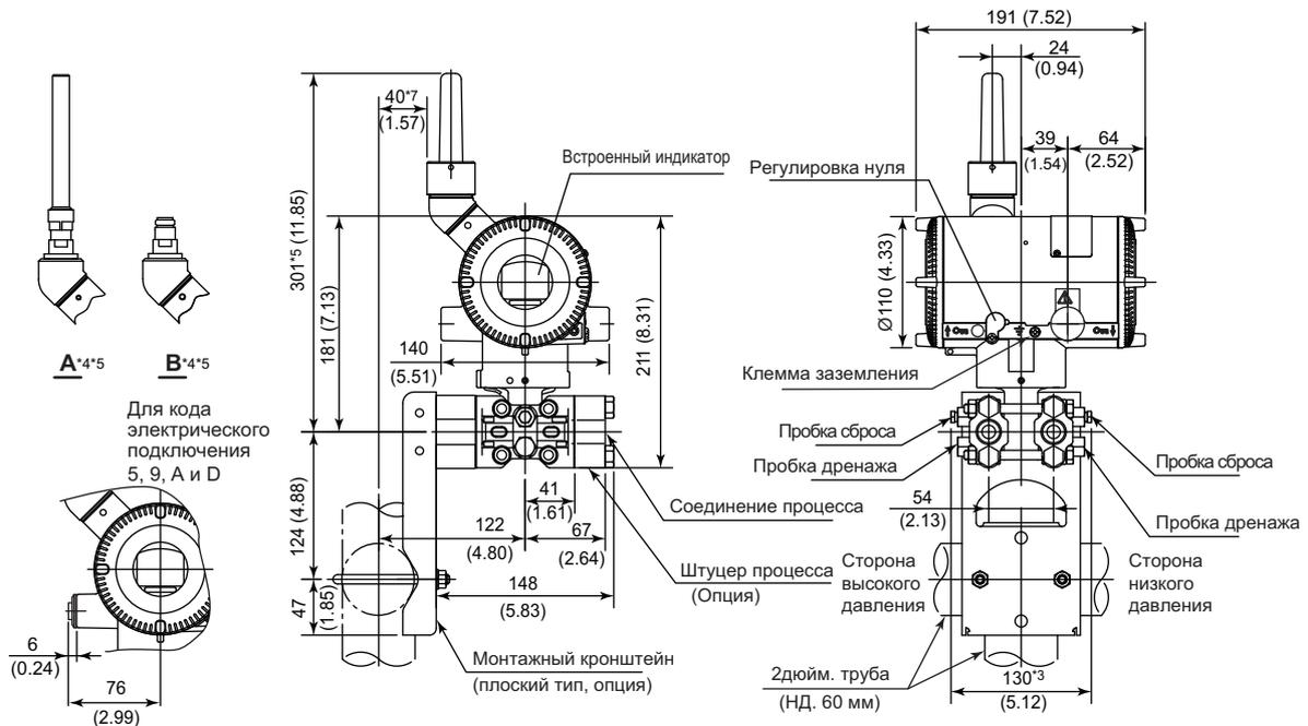
\*1: Если выбран код монтажа -8, то расположение сторон высокого и низкого давления противоположно показанному на рисунке (т.е. сторона высокого давления находится справа).
