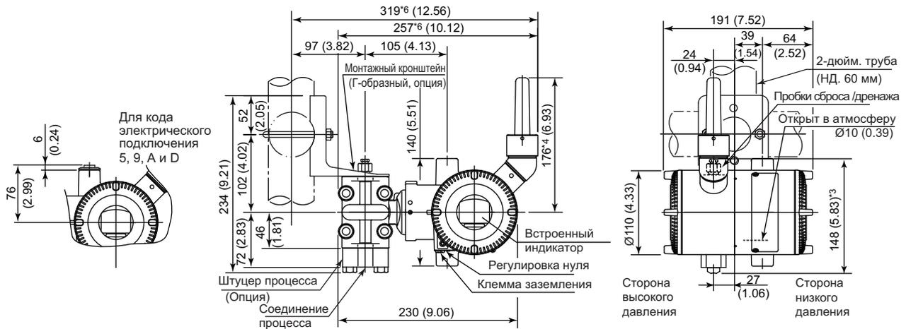
● Горизонтальная импульсная обвязка (Код монтажа -9 и код корпуса усилителя 7)<sup>\*1</sup>
