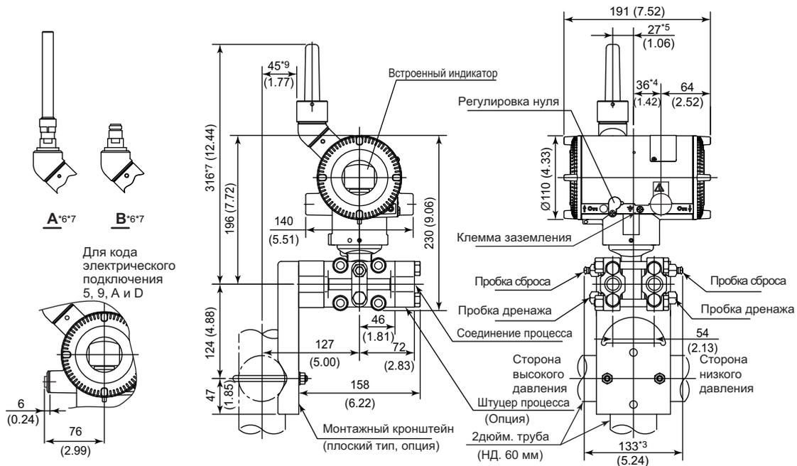
\*1: Если выбран код монтажа -8, то расположение сторон высокого и низкого давления противоположно показанному на рисунке (т.е. сторона высокого давления находится справа).
