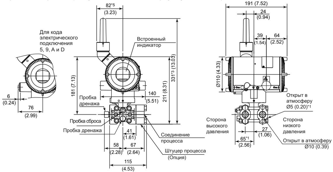
● Нижнее технологическое подключение (код установки -В и код корпуса усилителя 7)
