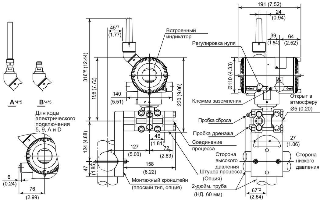
\*1: Если выбран код монтажа -3 и -8, то расположение сторон высокого и низкого давления противоположно показанному на рисунке (т.е. сторона высокого давления находится справа).
