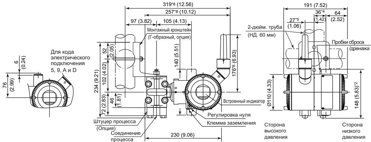
● Горизонтальная импульсная обвязка (Код монтажа -9 и код корпуса усилителя 7)\*1
