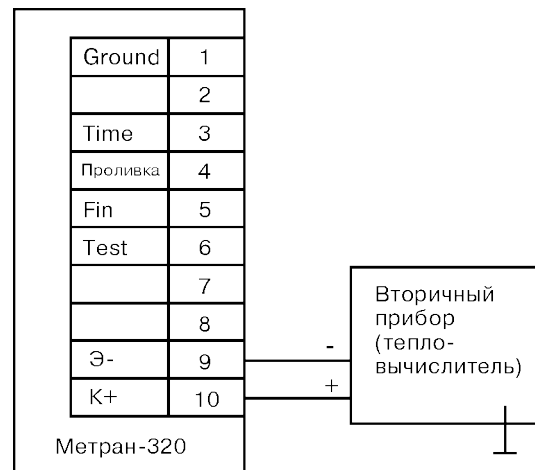
Рис. 1. Схема подключения расходомера Метран-320 к вторичному прибору.
