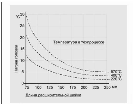
Рис. 5. Нагрев головки в зависимости от рабочей температуры
