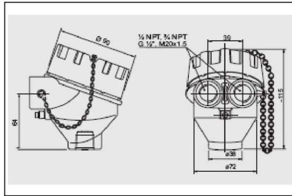
Рис. 4. Корпус TA21H.
