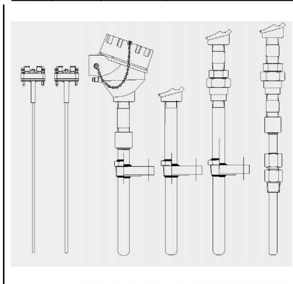
Корпус окрашенный, из алюминиевого сплава. Пригоден для размещения преобразователя и/или керамического блока вставки; степень "защиты от проникновения" - от IP66 до IP68.
