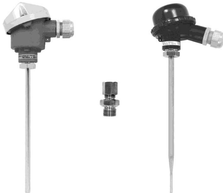
Датчики температурного диапазона TC 12 Omnigrad M представляют собой термопары, предназначенные для применения в производстве сверхчистых химических веществ, а также в других соответствующих областях. Датчик состоит из измерительного зонда с защитной гильзой и корпуса; в корпусе может устанавливаться преобразователь измеряемой величины. Благодаря модульной конфигурации и конструкции по стандарту DIN 43772 (форма 2/3) прибор TC 12 подходит для использования практически в любой отрасли.
