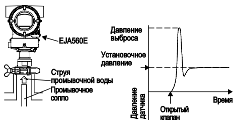
Рисунок 6. Прямой промыв датчика с использованием промывочной насадки
