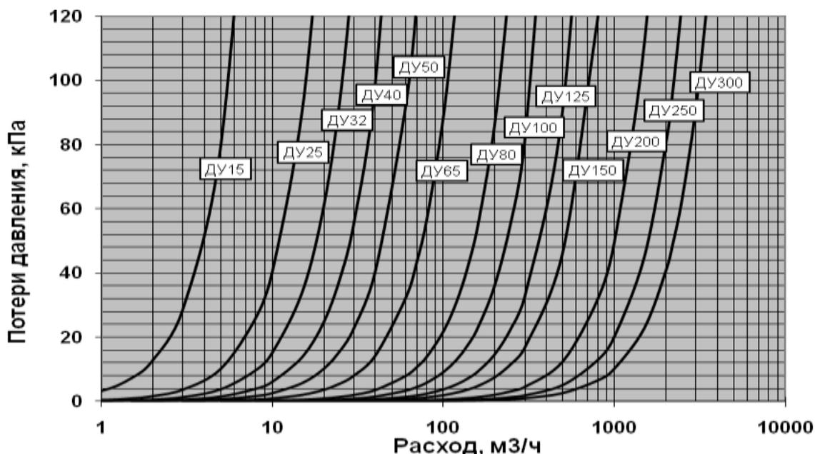
**Рисунок 2.1** – Графики потерь давления для воды
