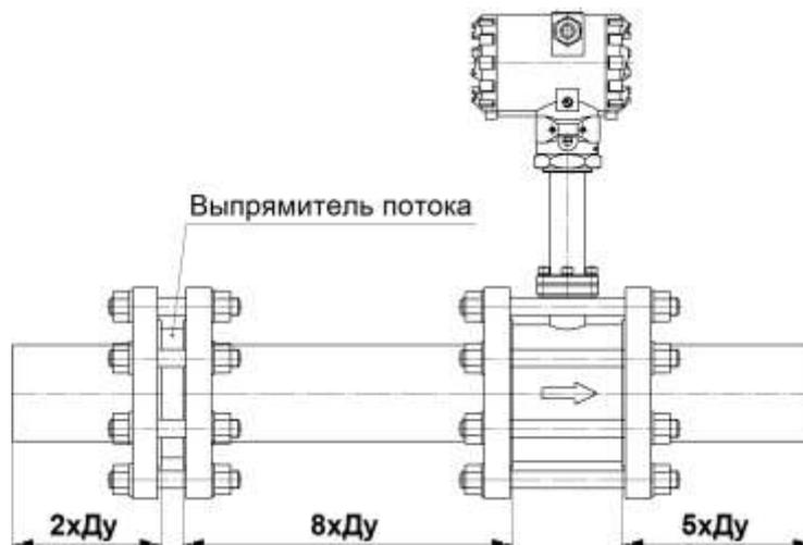
Рисунок 2.6 - Установка выпрямителя потока
