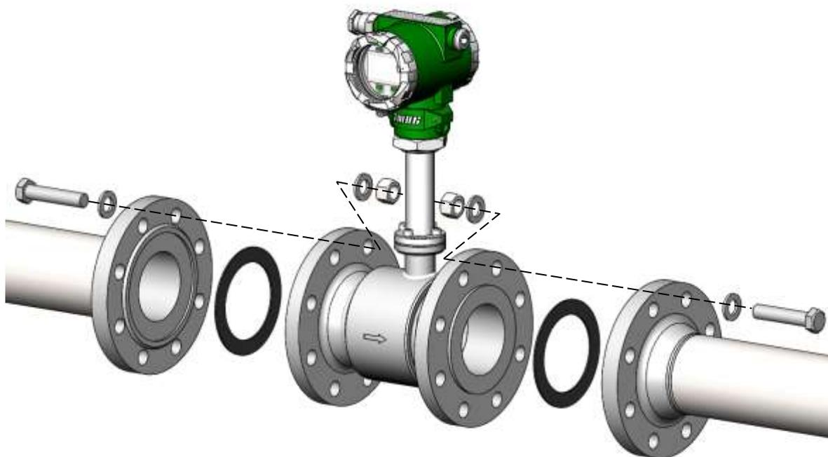
Рисунок Б.2 – Схема монтажа преобразователей фланцевых исполнений
