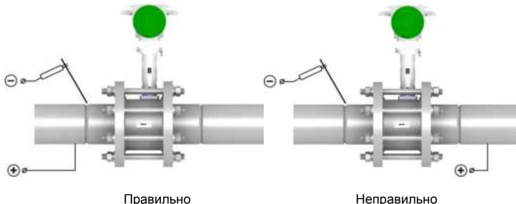
**Рисунок 2.11** – Подключение источника тока при электродуговой сварке
