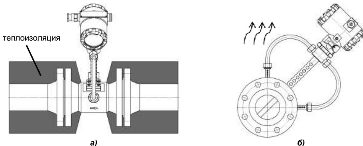
**Рисунок 2.9** – Установка преобразователя при повышенной температуре измеряемой среды
