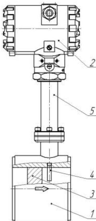
**Рисунок 1.1** – Устройство преобразователей расхода
