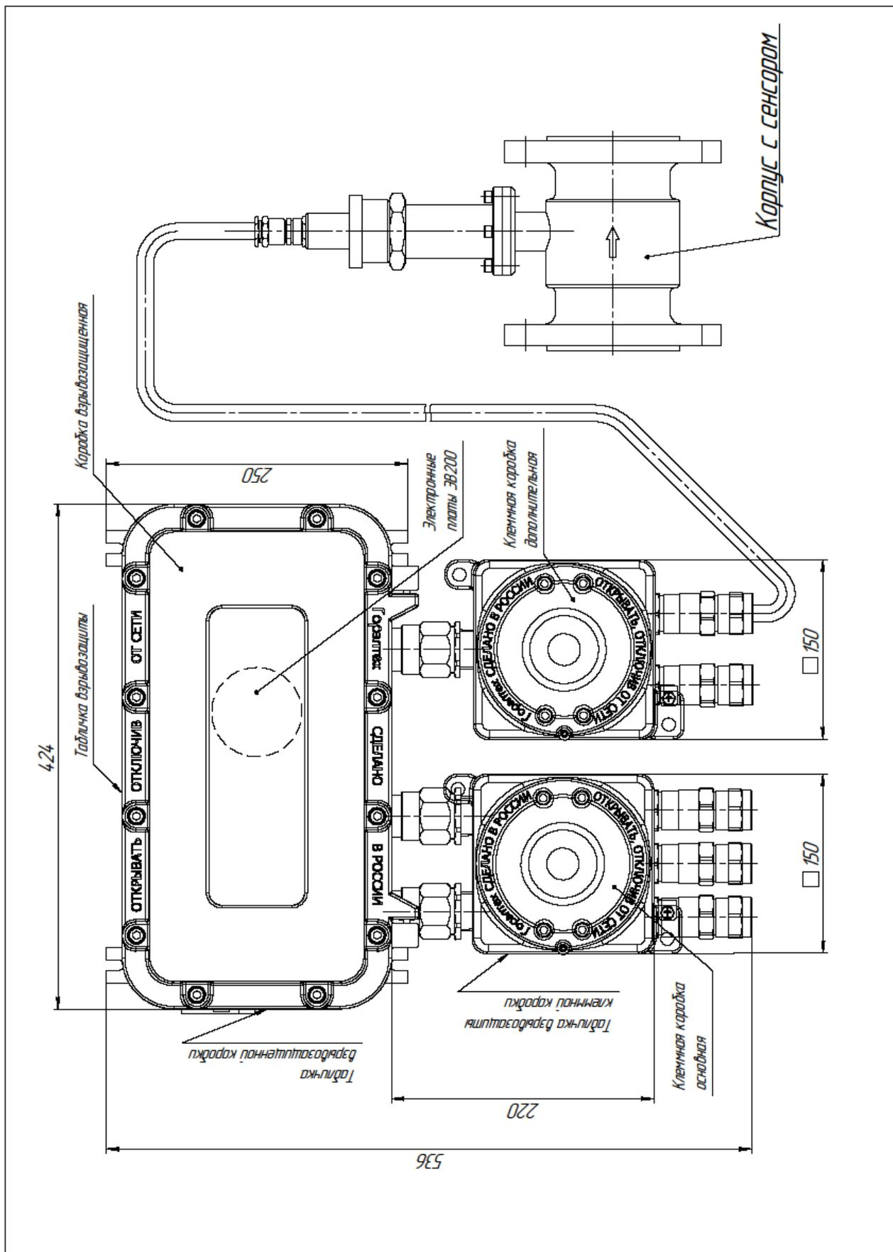
Рисунок В.13 – Размеры преобразователей рудничного исполнения PO-PB.
