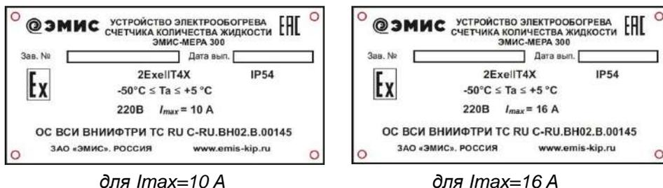
для  $I_{max}=10\text{ A}$ для  $I_{max}=16\text{ A}$ **Рисунок 1.10 – Табличка с маркировкой устройства электрообогрева**
