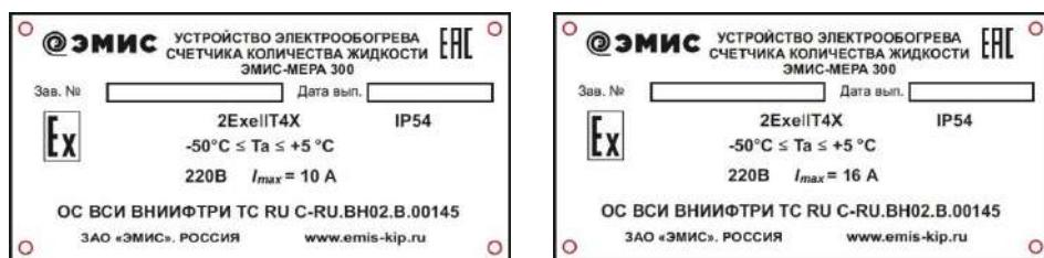
для  $I_{max}=10\text{ A}$ для  $I_{max}=16\text{ A}$ **Рисунок 1.10 – Табличка с маркировкой устройства электрообогрева**
