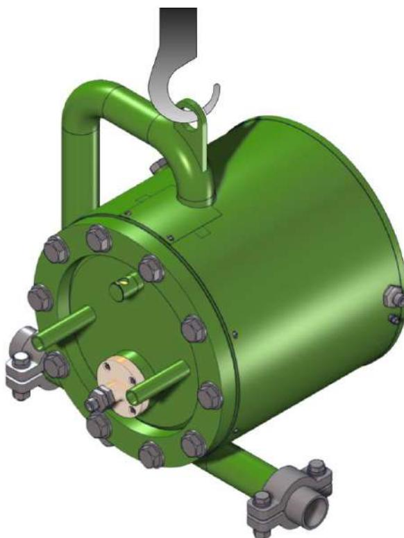
*Рисунок 3.1 – Правила транспортирования счетчика вне тары*
