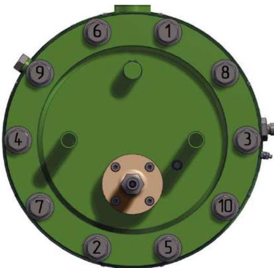
Рисунок 2.5 – Последовательность затяжки болтов фланца
