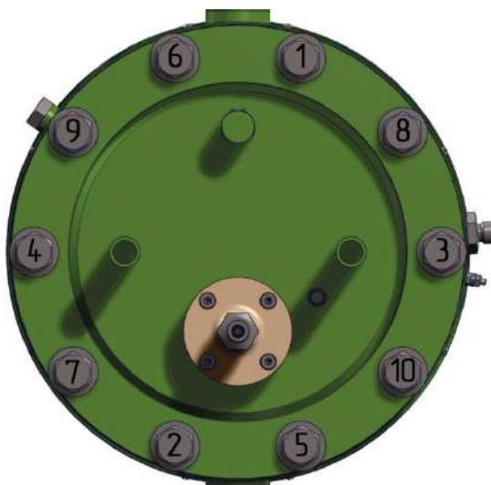
*Рисунок 2.5 – Последовательность затяжки болтов фланца*
