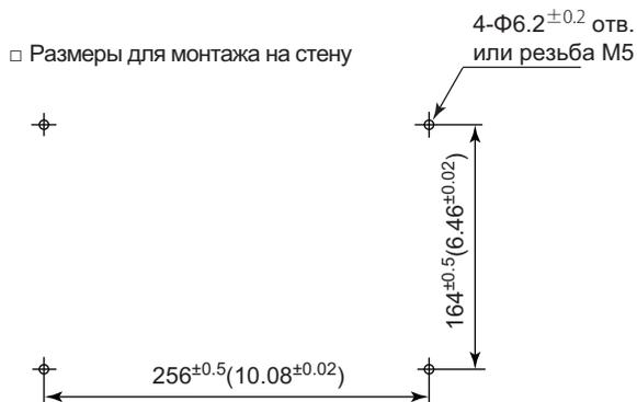
Примечание: Если не указано иное, допуск составляет 3%. Однако, для размеров менее 10 мм, допуск составляет 0,3 мм.
