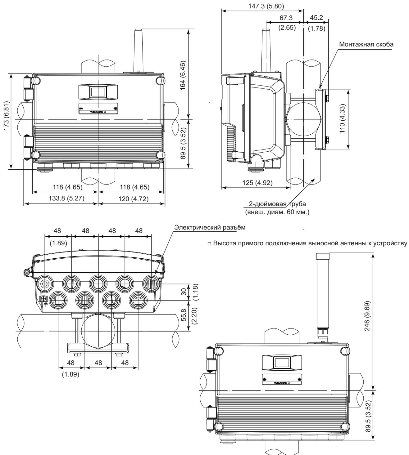
Если не указано иное, допуск составляет 3%. Однако, для размеров менее 10 мм, допуск составляет 0,3 мм.
