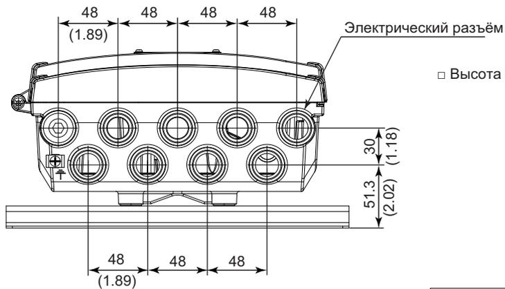
□ Высота прямого подключения выносной антенны к устройству
