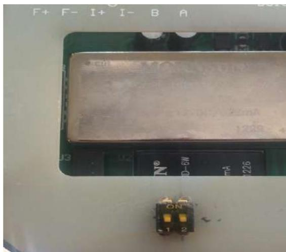
**Рисунок 2.25** *Дополнительный блок переключателей в положении OFF*
