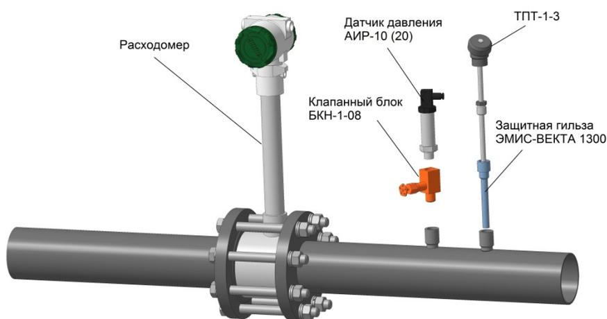
**Рисунок 2.20 – Монтаж преобразователя давления и температуры**
