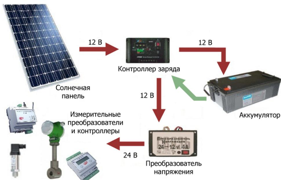
Рисунок 2.27 – Схема подключения узла в составе с солнечными
