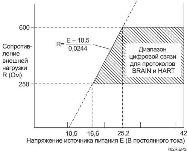
Рисунок 2. Связь напряжения питания и сопротивления внешней нагрузки
