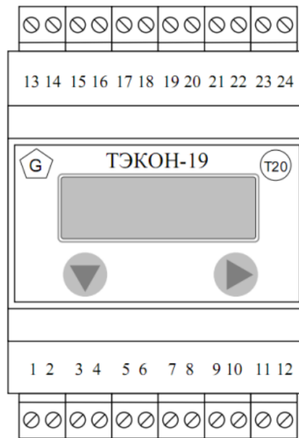
Рисунок 2.6 –Внешний вид передней панели и нумерация клемм ТЭКОН-19-05
