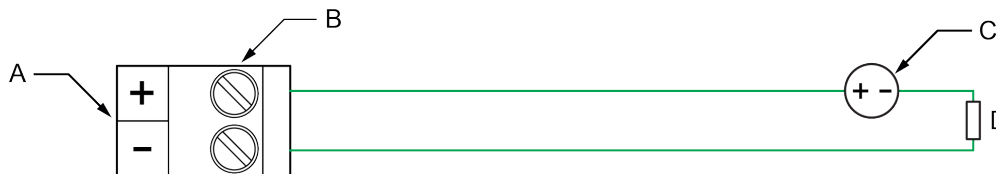
Рисунок 4-7. Подключение дискретного выхода к реле или индикатору
