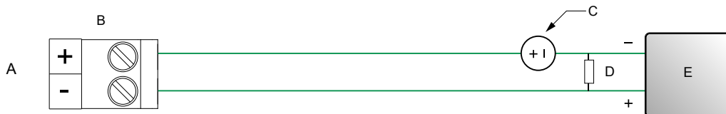
Рисунок 4-4. Подключение токового выхода (мА)
