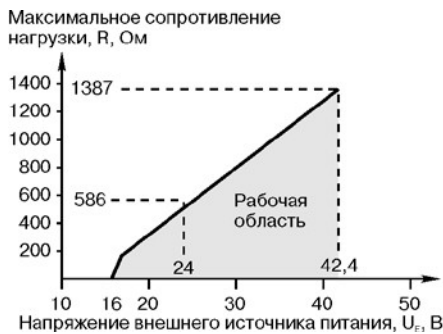
Рис. 15. Диаграмма сопротивлений для уровнемера в безопасной зоне.
