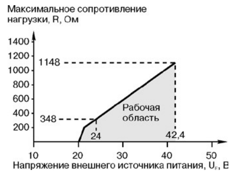
Рис. 17. Диаграмма сопротивлений для уровнемера, сертифицированного на взрывобезопасность.
