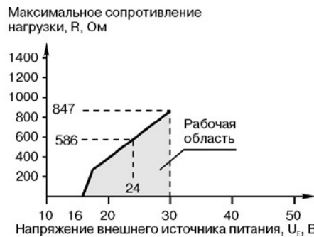
Рис. 16. Диаграмма сопротивлений для уровнемера, сертифицированного на искробезопасность.
