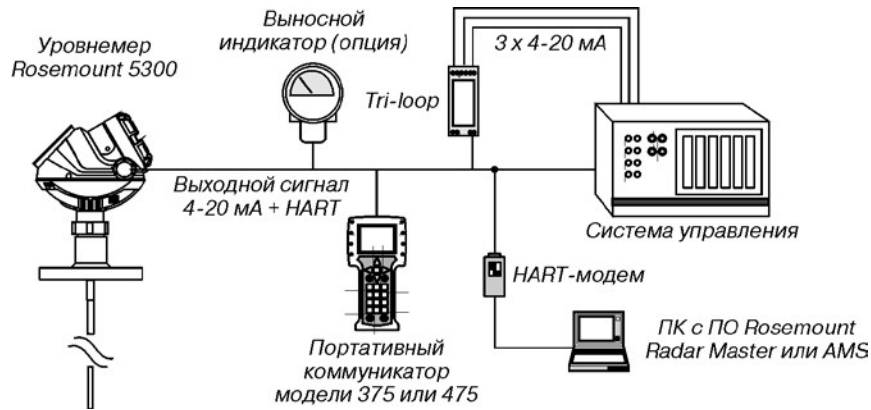
Рис.23. Интеграция в систему с использованием HART-протокола.
