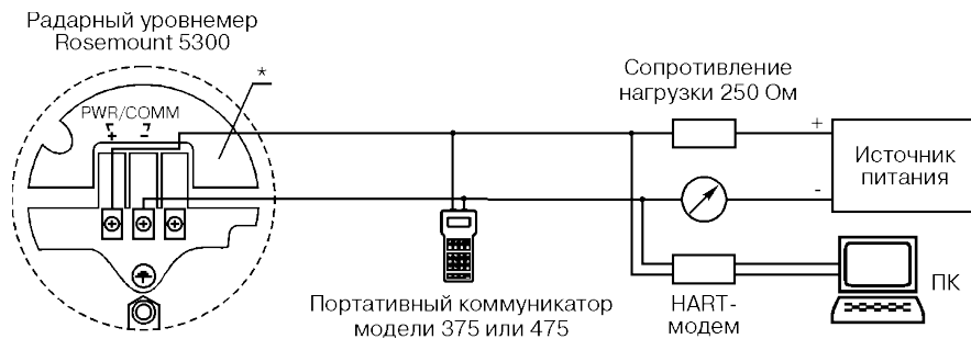
* При температуре внутри корпуса около 60°C рекомендуется использовать проводку, рассчитанную как минимум на 90°C. Рис. 17.
