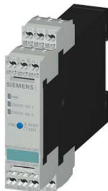
AS-i, разъединитель данных 2 x 4 А Пружинные клеммы, AS-i, двойной Развязывающий модуль данных IP20, SlimLine S22,5 пружинные клеммы Установочная ширина модуля 22,5 мм IN: 24 В/30 В DC OUT: 2 x AS-i, 4 А встроенная защита от перегрузки встроенное обнаружение замыкания на землю Сигнальный контакт Дистанционный сброс
