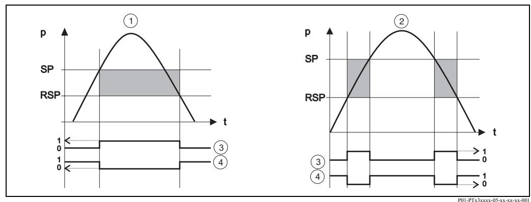
↗ Функция гистерезиса, (2) Функция окна, (3) Состояние контакта реле НР, (4) Состояние контакта реле НЗ
