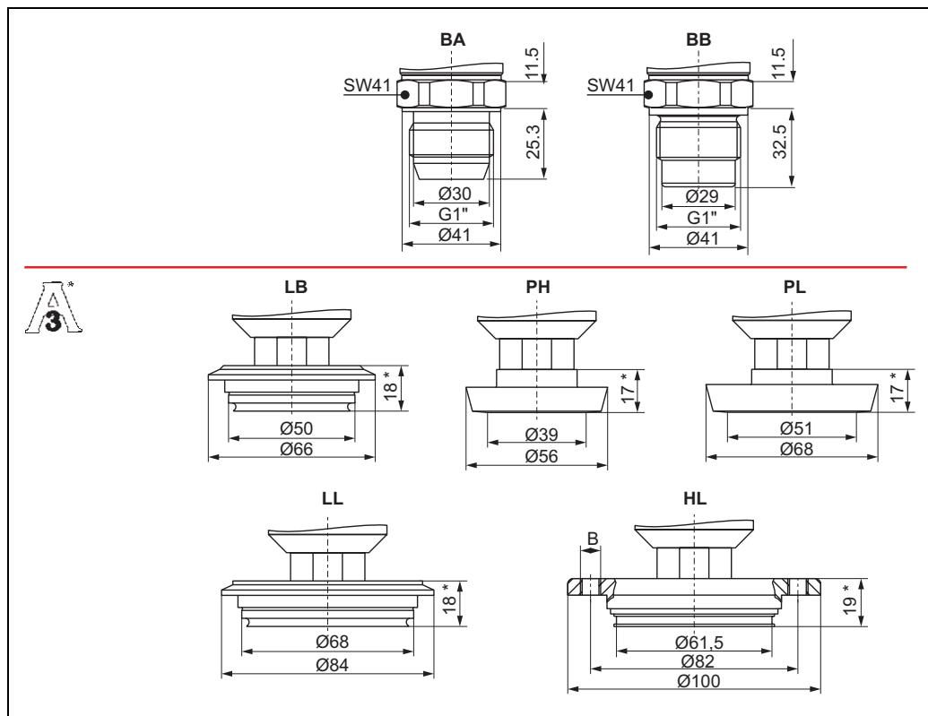
Исполнения подключения в процесс
