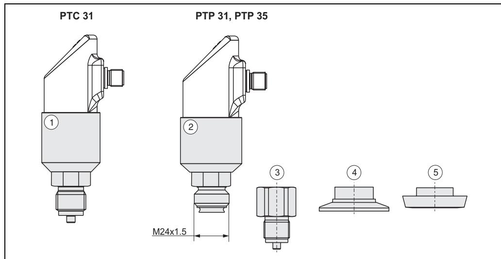
PTC 31: модуль сенсора (1) с подключением в процесс.
