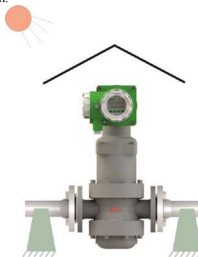
Рисунок. 2.5 - Общие требования к месту установки счетчика
