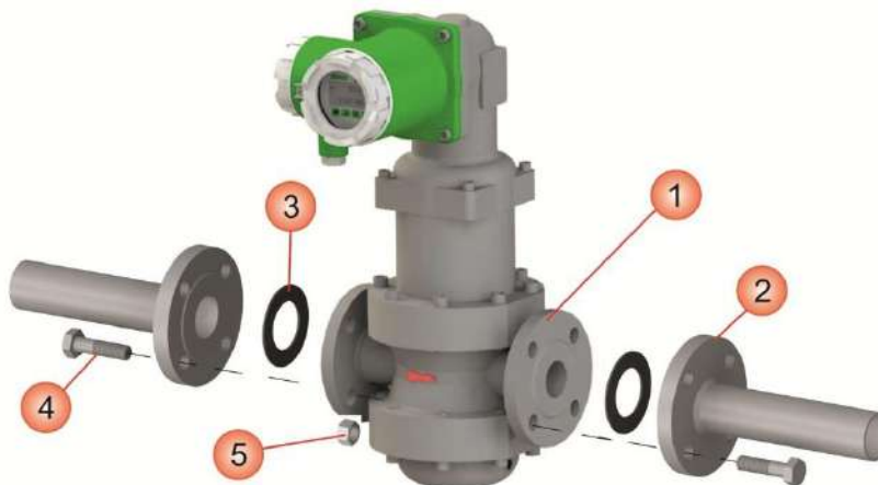
Рисунок 2.9 - Установка счетчика ЭМИС-ДИО 230 на трубопровод
